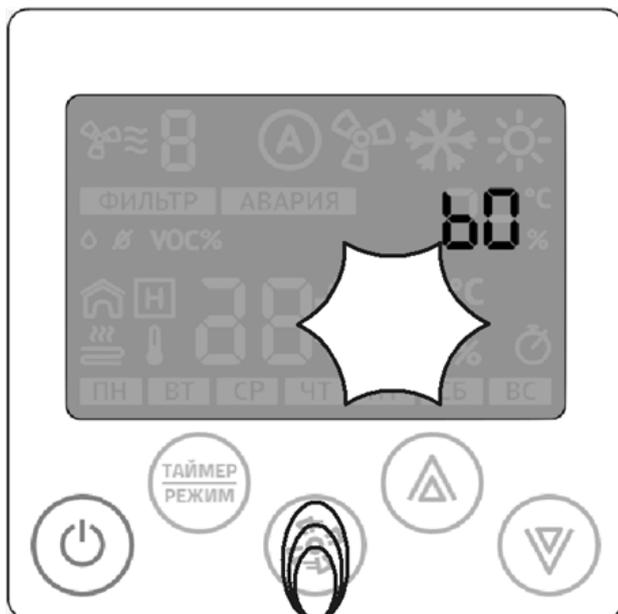
Кнопка «вентилятор» переключит режим выбора параметра на режим ввода значения параметра, жим смены группы параметров. Кнопка «вниз» или «вверх» будет менять значение выбранного параметра.
