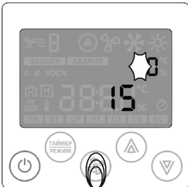
Кнопка «вентилятор» переключит режим ввода значения выбранного параметра в ре-параметра, жим смены группы параметров. Кнопка «вниз» или «вверх» будет менять значение выбранного параметра.
